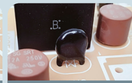
異常電壓保護裝置
