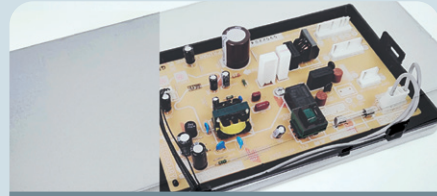
電路板保護殼覆蓋板金
