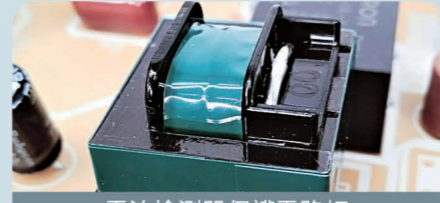
電流檢測器保護電路板 過載時停止壓縮機
