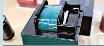
電流檢測器保護電路板 過載時停止壓縮機
