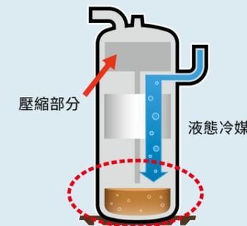
液態冷媒先到達底部
